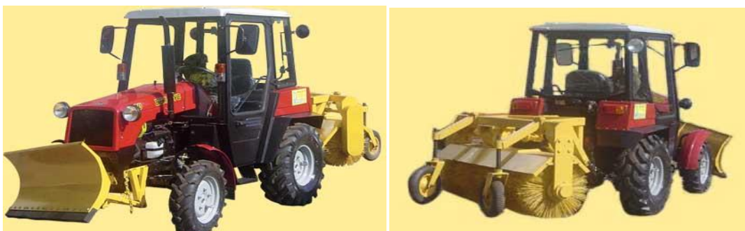
Рис. 27. машина МКК-10 на базе трактора МТЗ-320
