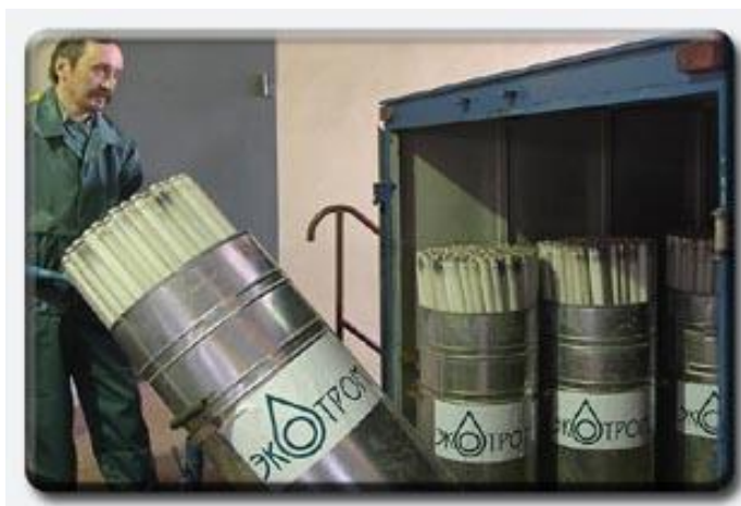
Рис. 18 Контейнеры, используемые для хранения и транспортировки люминесцентных ламп
