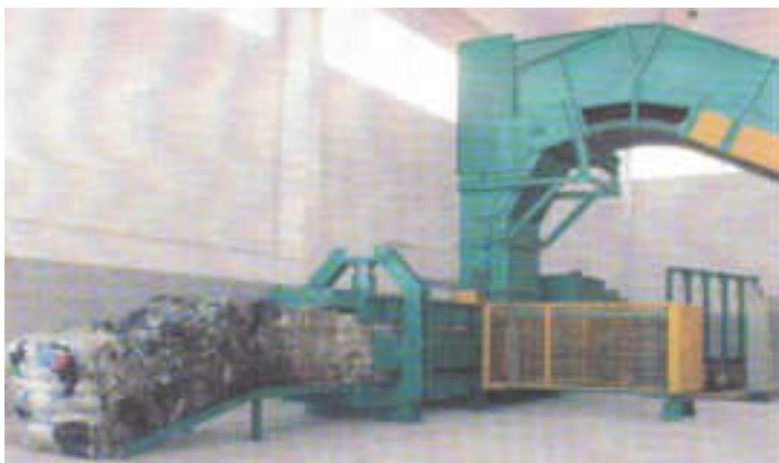
Прессовальная установка на станции сбора и обработки вторсырья
